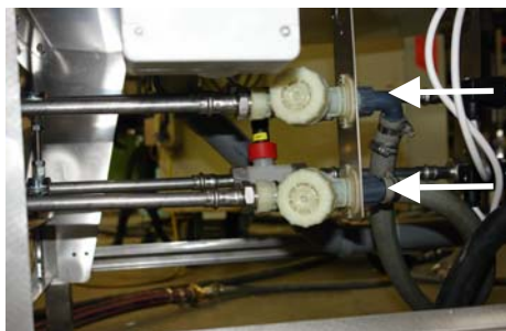
Maskinens vandtilslutning er placeret under udløbet.
